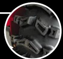
Die griffigen Lamellenwinterreifen sorgen für exzellente Haftung auch ohne Schneeketten
